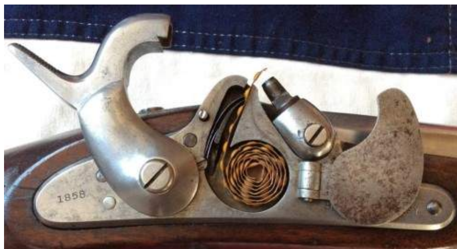
Figura 8 - Sistema de ignição de uma espingarda por percussão externa.
