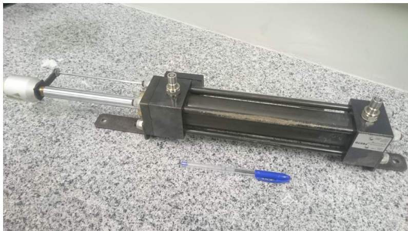
Figura 7 – Atuador hidráulico de dupla ação.
