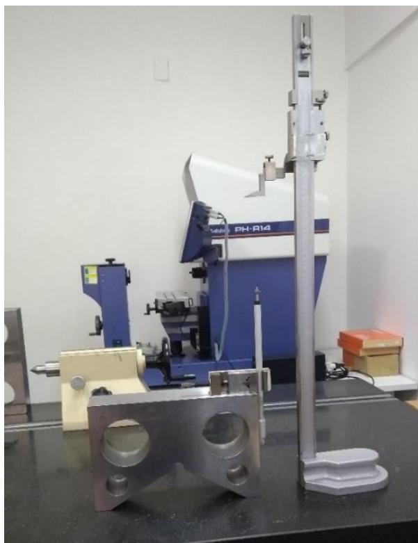
Figura 15 – Esquema montado para calibração do potenciômetro linear.
