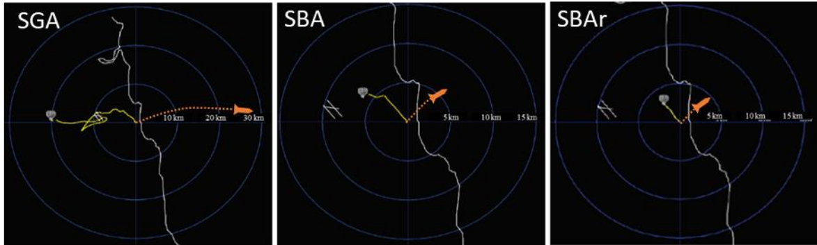
Figura 38 – Perfil do deslocamento horizontal do balão de sondagem atmosférico no CLBI.
