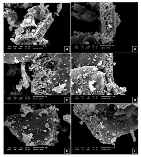
Figure 5. SEM images of MgAl<sub>2</sub>O<sub>4</sub>. A) 700 °C/2 h, B) 700 °C/4 h, C) 900 °C/2 h, D) 900 °C/4 h, E) 1100 °C/2 h and F) 1100 °C/4 h.
