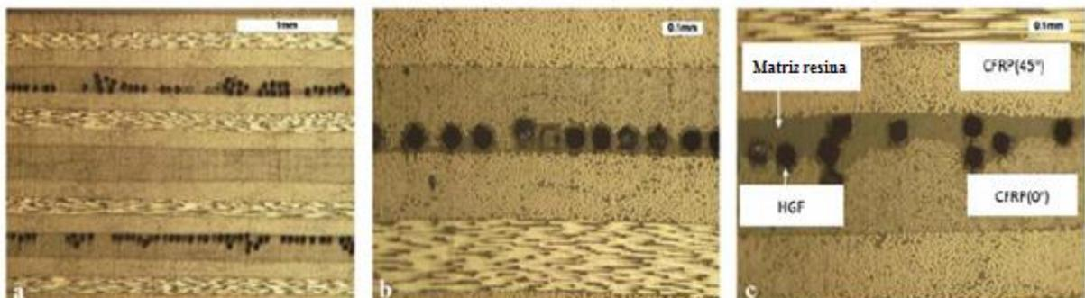
Figura 3-5: Composição do mecanismo de autorreparo vascular pela inserção de agentes de reparo no interior de fibras ociosas [22].
