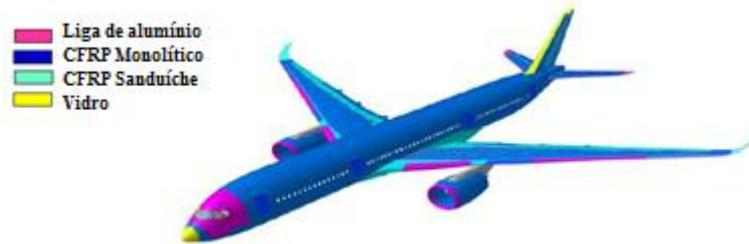
Figura 1-1: Airbus A350 XWB – Aeronave com uma porcentagem superior a 50% do peso vazio composta por materiais compósitos [5].
