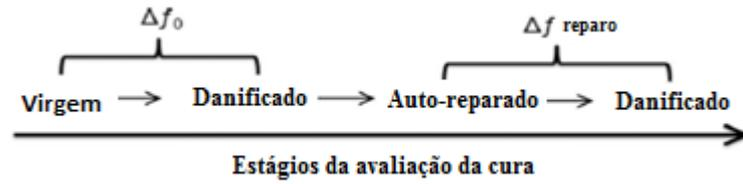
Figura 3-2: Avaliação da eficiência do autorreparo pela comparação da mudança entre a função do material virgem e reparado [23].
