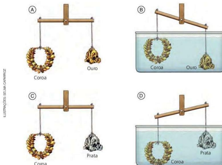
Figura 5.2 (A) Coroa e bloco de ouro de massas iguais, em equilíbrio no ar; (B) dentro da água, a coroa tem peso aparente menor que o bloco de ouro; (C) coroa e bloco de prata de massas iguais, em equilíbrio no ar; (D) dentro da água, a coroa tem peso aparente maior que o bloco de prata.
