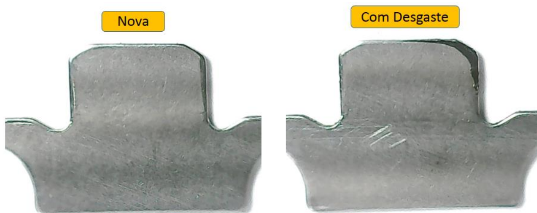
Figura 21 – Imagem Ampliada do Pé da Agulha Nova e Desgastada
