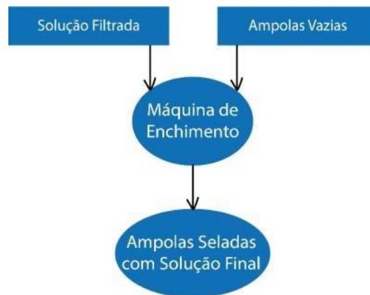
Figura 7 – Fase IV: Enchimento das Ampolas
