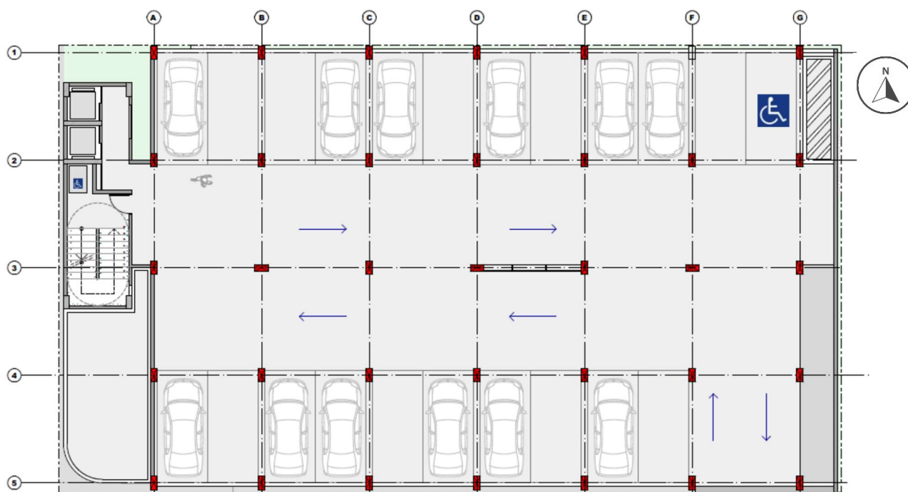
Figura 66: : Planta Baixa – Estacionamento
