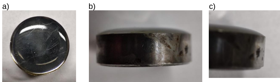
Figura 12. Fotos do revestimento apenas de epóxi pós cura. (a) vista superior, (b) vista lateral e (c) vista mais próxima da borda.
