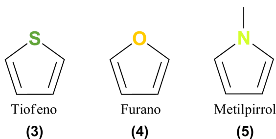
Figura 6 - Estruturas de tiofeno, furano e metilpirrol
