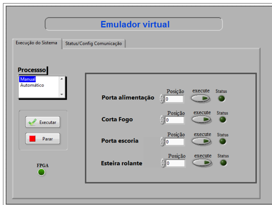
Figura 5.15: Sistema de supervisão principal do emulador virtual.
