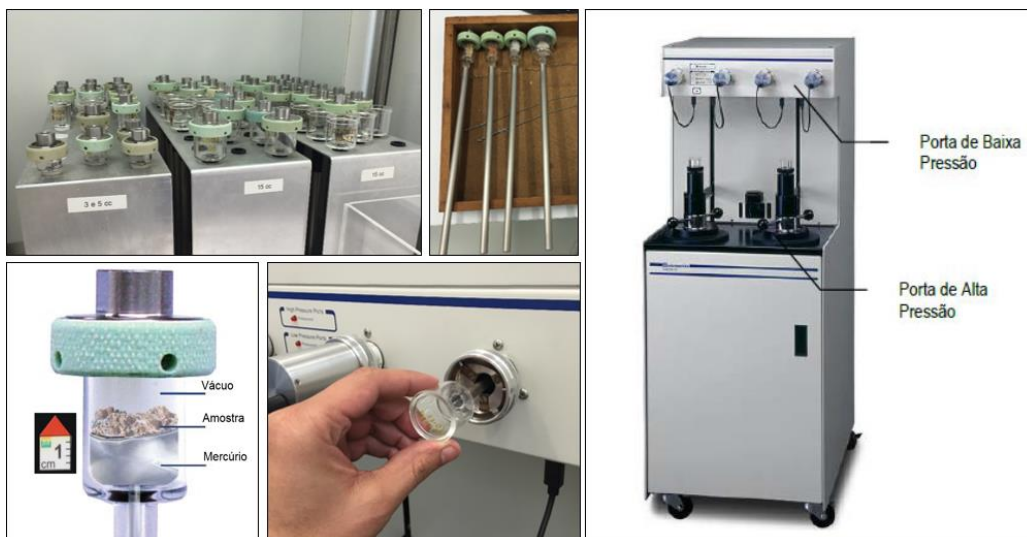
Figura 3.3 – Equipamentos utilizados nas análises de pressão capilar por injeção de mercúrio (modificado de McPhee et al. , 2015).
