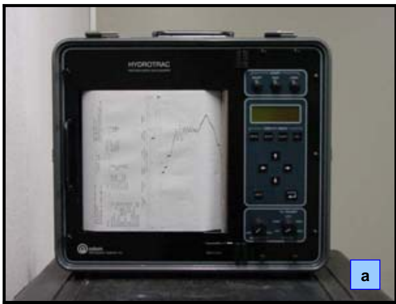
Figura 2.6 – Conjunto de equipamentos utilizados na atividade de campo para realização da sísmica de reflexão: a) Registrador “Hydrotac” fabricado pela Odom Hydrographic System
