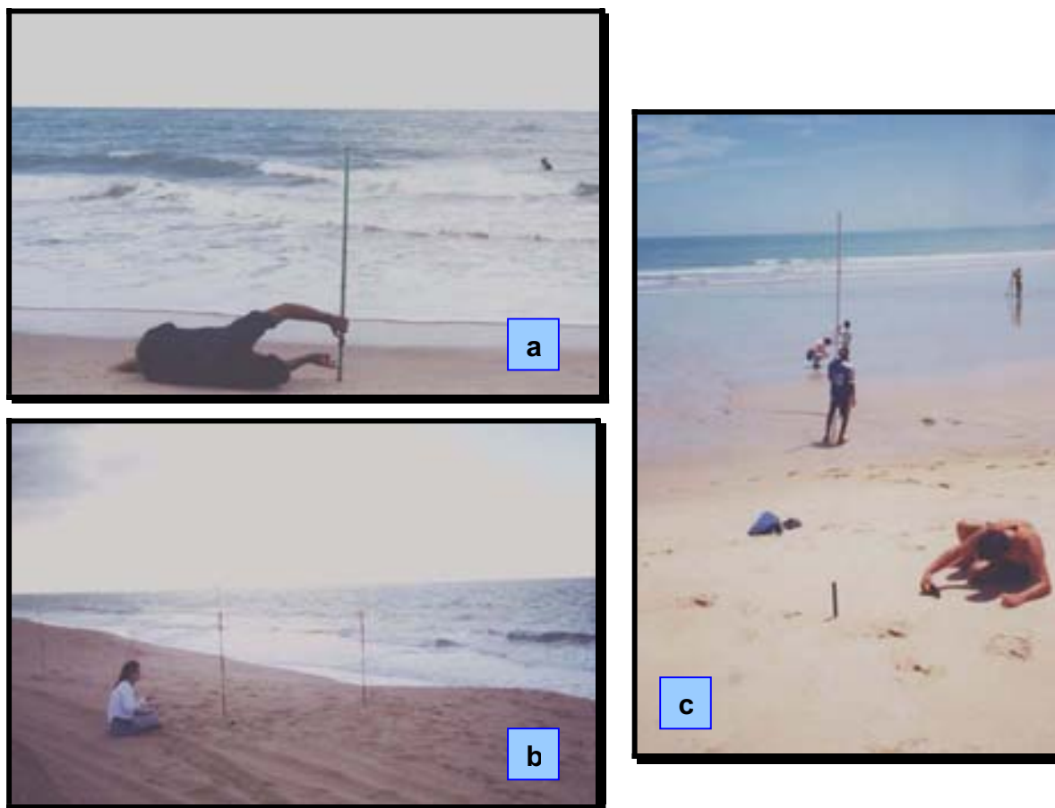
Figura 2.4 – Metodologia adotada durante o trabalho de campo para caracterização dos dados de hidrodinâmica, onde as medições foram realizadas por meio de observações visuais durante o período de 14 meses, durante o estágio de preamar (maré mais alta). Os pontos de observações foram escolhidos em função da área de maior influência e que melhor caracteriza-se a faixa costeira, as áreas selecionadas envolvem os perfis 01 e perfil 06; a) altura das ondas, b) velocidade e direção da deriva litorânea, tipo de arrebentação e incidência das ondas sobre a praia, c) ângulo de inclinação do terreno na zona de estirâncio (declividade do terreno). (Fotografado em 05/07/2001, fotos Zuleide Lima).
