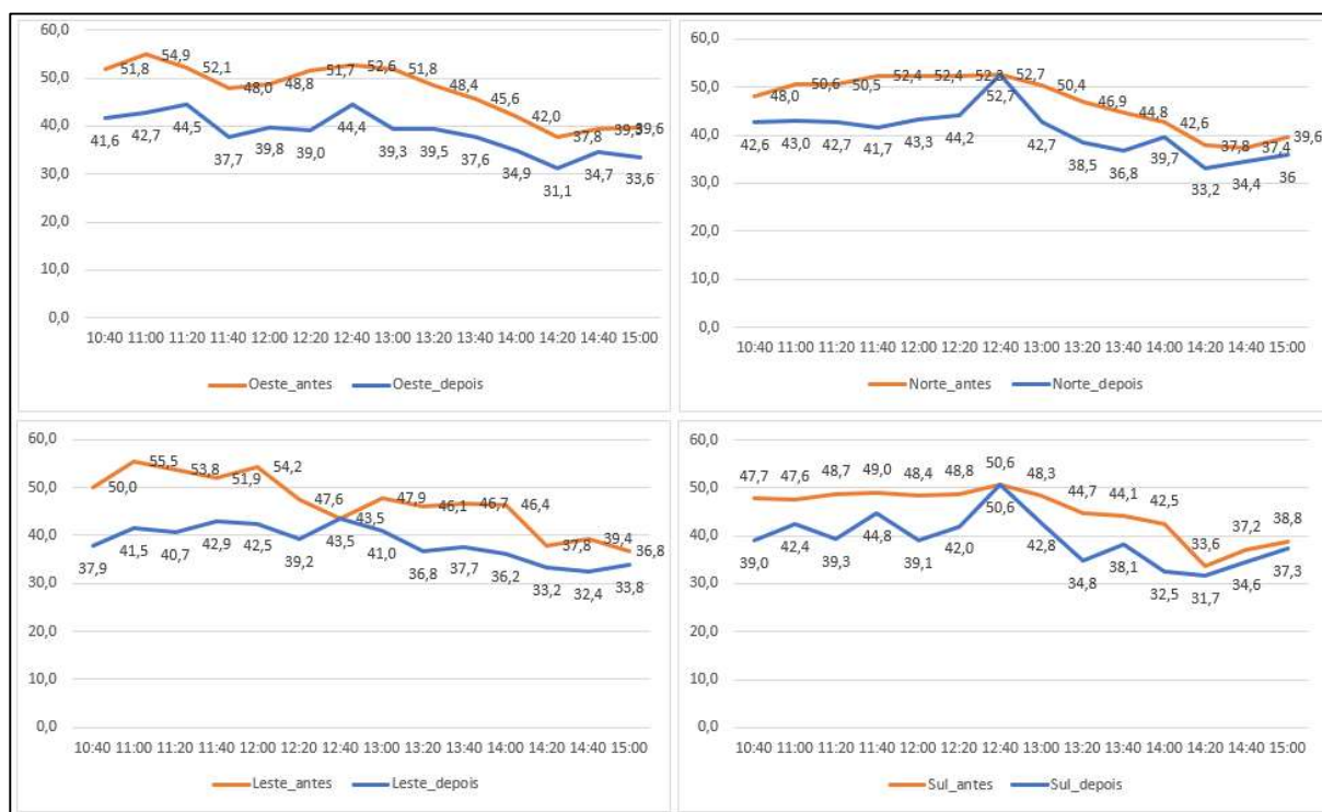
Figura 63 : Gráficos de diferenças de temperaturas obtidas antes e depois de molhar os vitrais em todas as direções
