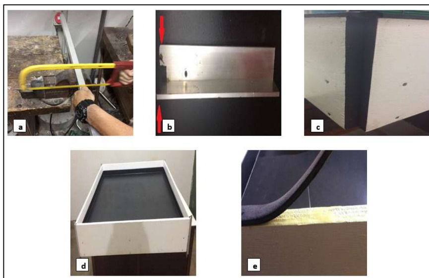
Figura 39: Colocação das cantoneiras nas laterais e das vedações
