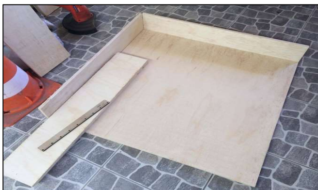
Figura 35: Fabricação da parede lateral do destilador
