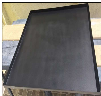
Figura 38: Bandeja com superfície enegrecida – placa absorvedora
