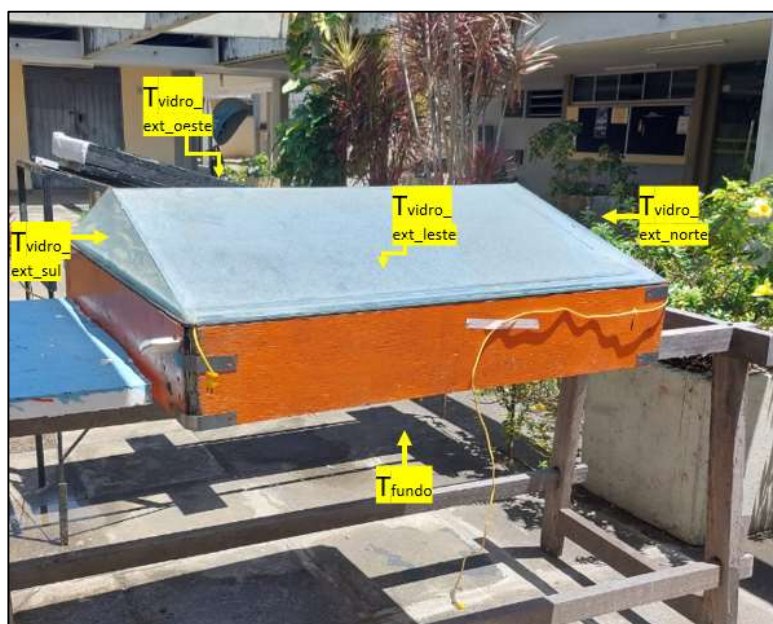
Figura 45: Temperaturas medidas externamente
