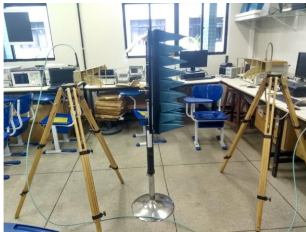
Figura 3-1 – Setup de medição para caracterização experimental das BFSS.
