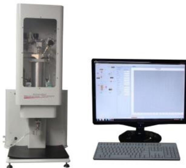
Figura 18 - Coreval 700, mede na pressão de confinamento de sobrecarga (400 psi a 10.000 psi)
