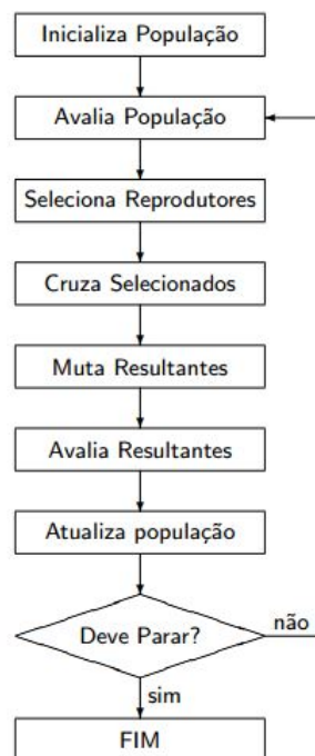
Figura 2.7: Estrutura de funcionamento de um algoritmo genético tradicional.
