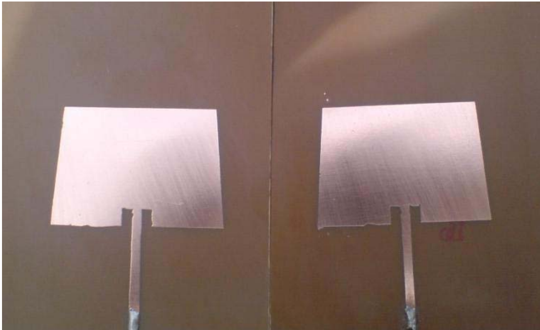
Figura 5.3: Protótipos usados no arranjo de dois elementos com antenas de microfita de patches afilados.
