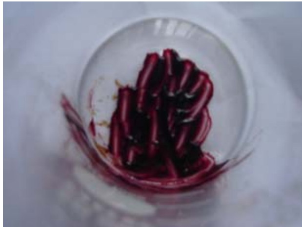
FIGURA 26 – Produto da eletrolise de LCC técnico no eletrólito metanol mais NaOH (LSODA)
