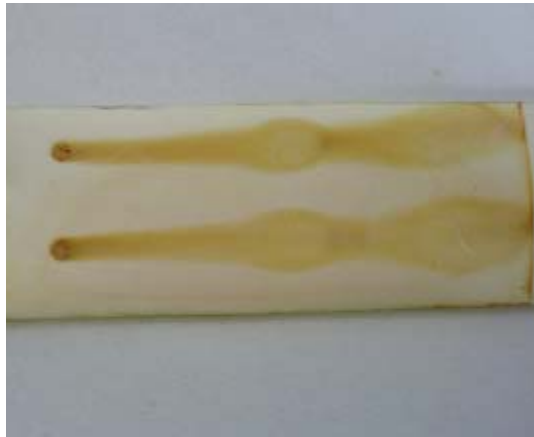
FIGURA 29 – Cromatografia de Camada Delgada com LCC técnico e o LCC eletrolisado em meio ácido (LACAC)
