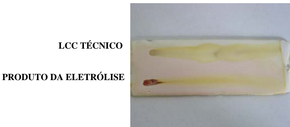
FIGURA 27 – Cromatografia de Camada Delgada do LCC técnico e produto da eletrolise em eletrólito metanol mais NaOH (LSODA)
