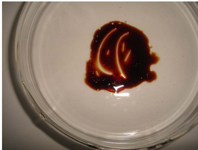
FIGURA 28 – Produto da eletrolise do LCC técnico no eletrólito metanol mais ácido acético (LACAC)
