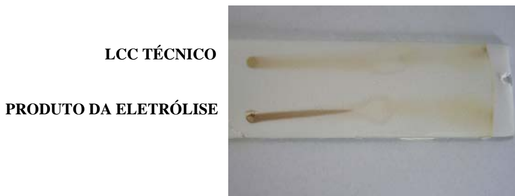
FIGURA 31 – Cromatografia de Camada Delgada com LCC técnico e o LCC eletrolisado no eletrólito metanol mais cloreto de sódio (LSAL)
