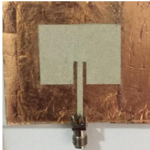
Figura 0.13 - Fotografia do protótipo da antena de microfita em substrato de vidro pintado com tinta de prata.
