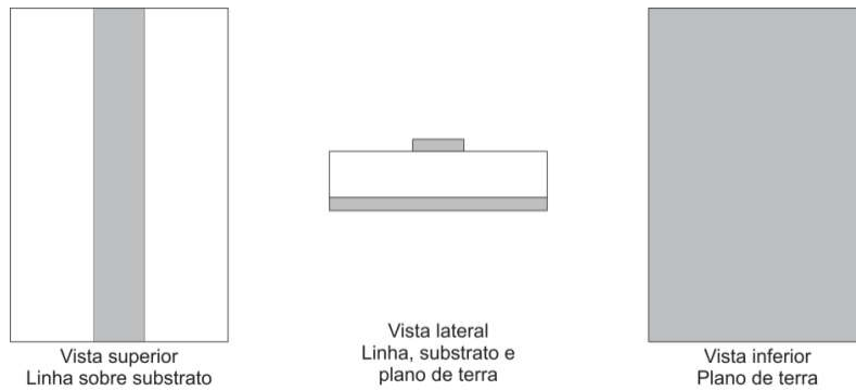
Figura 3.2.4: Esquemático de uma linha de microfita hipotética. Fonte: [14].
