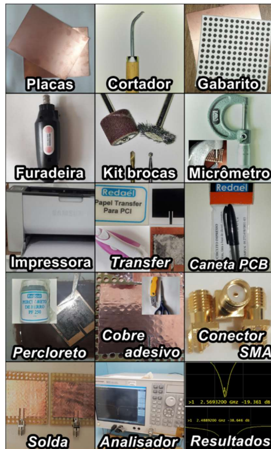
Figura 4.2.3: Materiais para as estruturas na ordem das etapas da produção. Fonte: Autoria própria.
