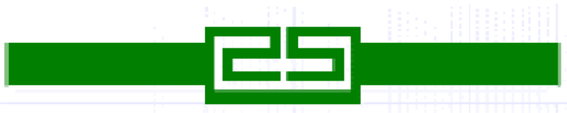
Figura 3.4: Ressonador baseado na geometria Matrioska, L_{1ext} = 17,6mm , L_{2ext} = 13,6,6mm .
