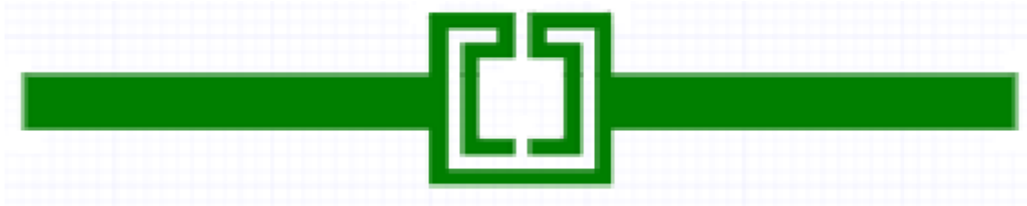
Figura 3.2: Ressonador baseado na geometria Matrioska, L_{1ext} = 11,6mm , L_{2ext} = 7,6mm .
