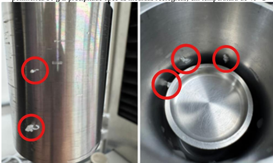
Figura 24 – Aspecto do copolímero CMC1- g -PNIPAM6 em água do mar sintética (AMS), concentração polimérica 30 g/L precipitado após as medidas reológicas, em temperatura de 40 °C
