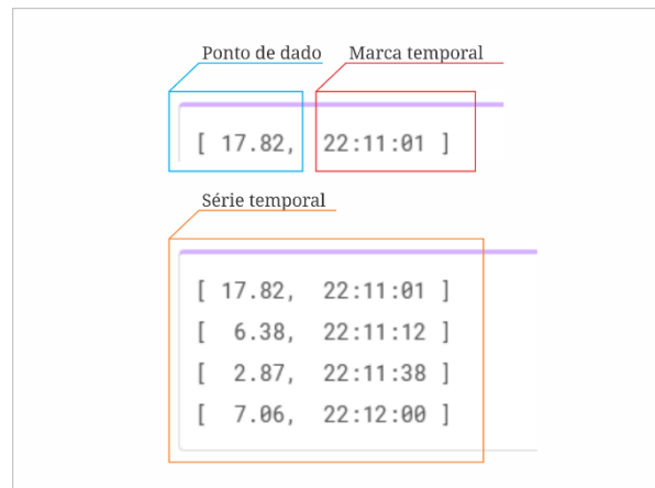
Figura 11 – Exemplo de como o Datadog armazena métricas
