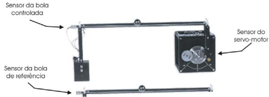
Figura 4.1: Localização dos sensores no sistema ball and beam .
