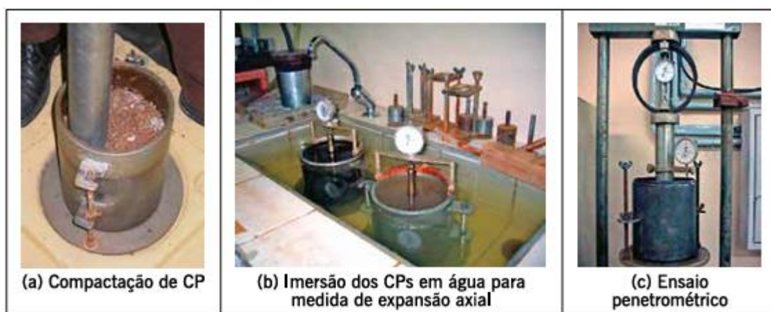
Figura 6 - Ensaio de CBR e Expansão
