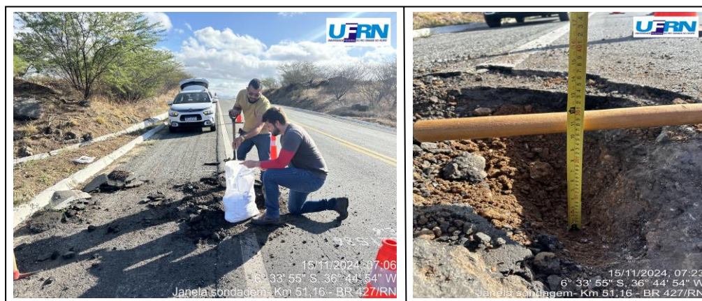
Figura 20 - Coleta e medição do material de base, km 51,16
