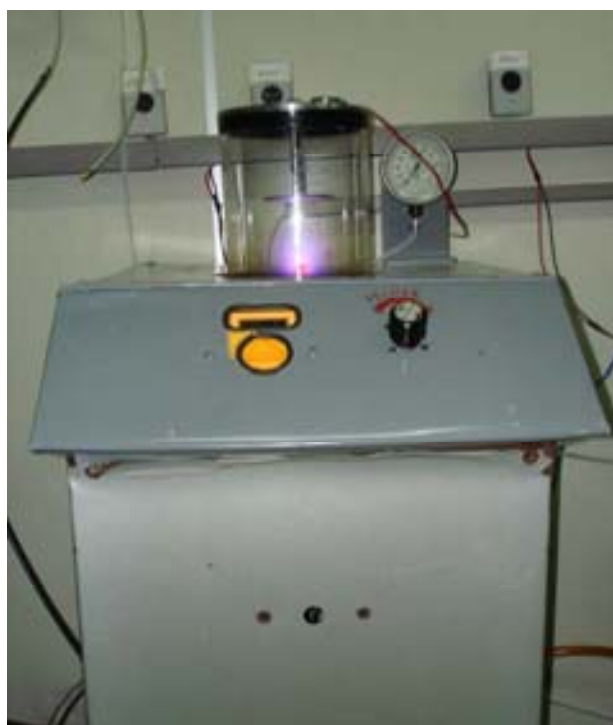
Figura 8 – Reator a plasma utilizado na redução das misturas de Ta_2O_5 e Al.
