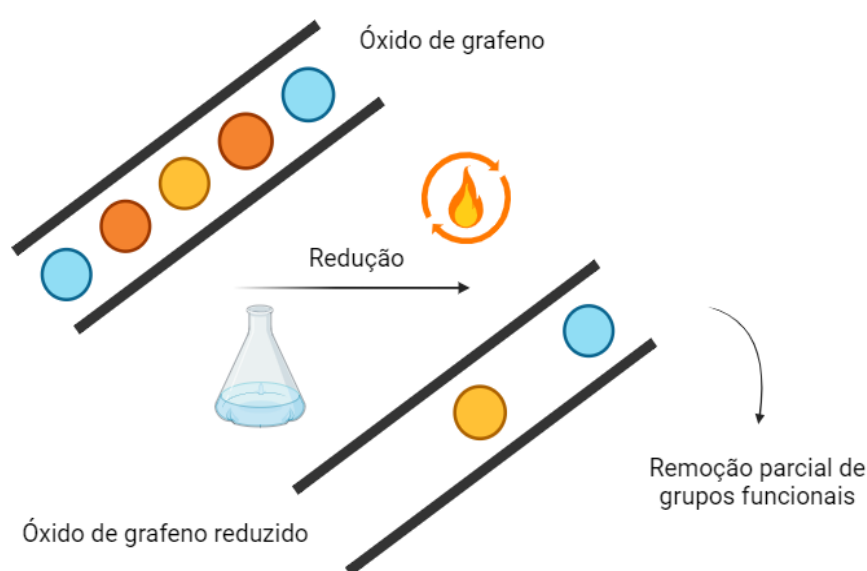
Figura 6. Procedimento de redução do GO para nanoplaquetas de rGO (Fonte: autor)
