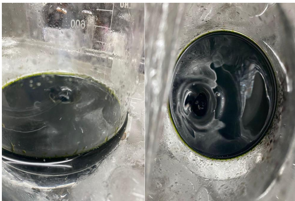
Figura 12. Adição de \text{KMnO}_4 à solução (Fonte: autor)
