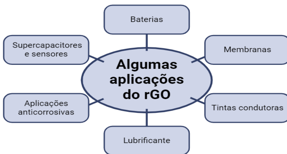
Figura 8. Aplicações das nanoplaquetas de rGO (Fonte: adaptado de TARCAN et al. , 2020)
