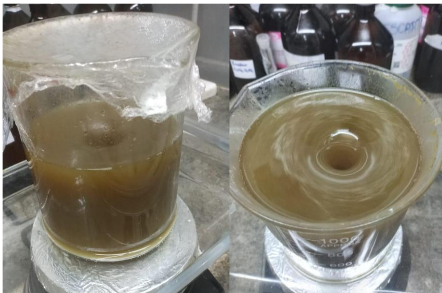
Figura 13. Adição de H_2O_2 à solução (Fonte: autor)
