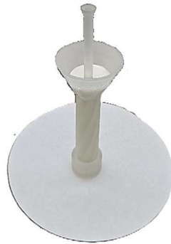
Figura 45 - Molde impresso 3D em resina AnycuBIC.
