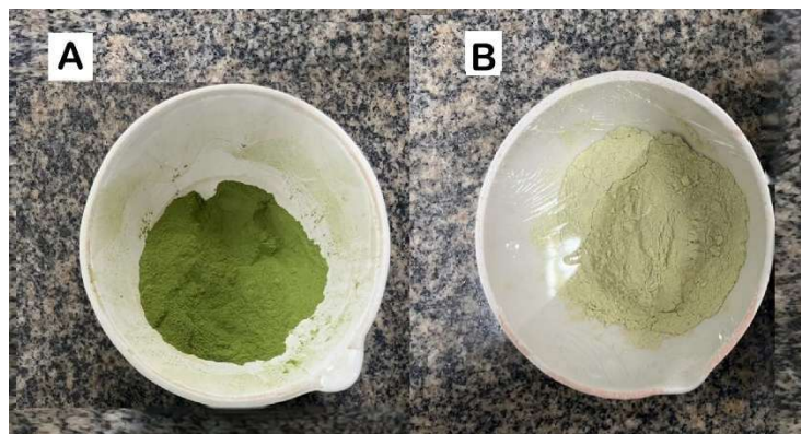
Figura 34 – (A) ácido túngstico seco da lixiviação e (B) \text{WO}_3 da calcinação subsequente.
