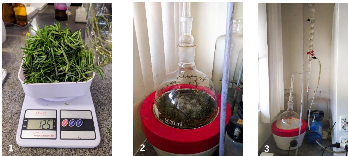
Figura 6. Procedimento para a extração do óleo essencial de R. officinalis (1) Pesagem do material vegetal (2) extração do óleo essencial pela técnica de hidrodestilação (3) Aparelho de Clevenger acoplado ao balão volumétrico.
