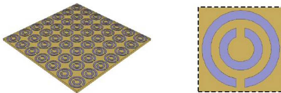
Figura 3.5: Arranjo de ressoadores metálicos para obter \mu < 0 .
