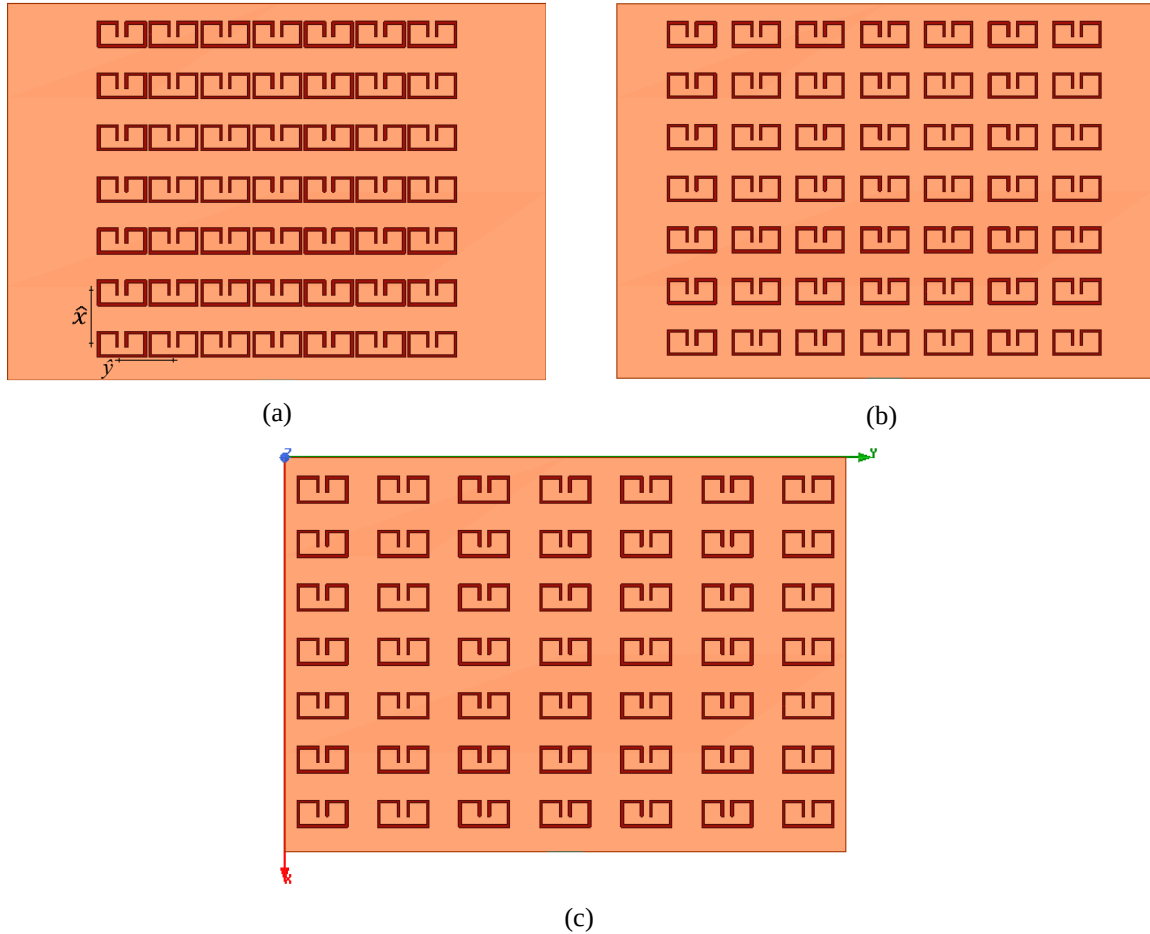
Figura 4.11: Arranjo em visão superior em 0 graus com direção \pm\hat{x} em 4 mm e com \Lambda_0 em \pm\hat{y} (a) 4 mm, (b) 5 mm e (c) 6 mm.
