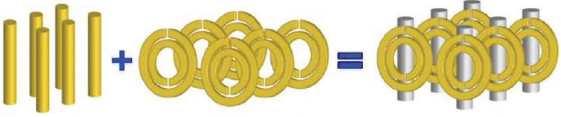
Figura 3.6: Arranjo de condutores e ressoadores em paralelo para \varepsilon < 0 e \mu < 0 .
