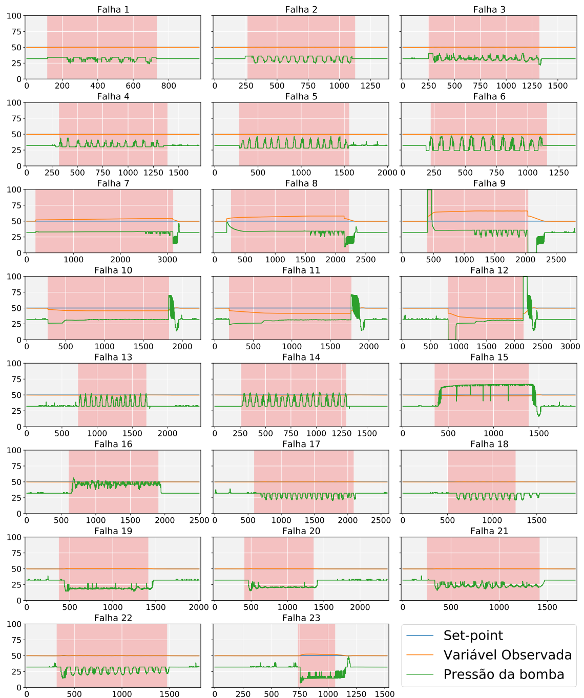
Figura 5.3: Exibição da influência das 23 falhas sobre uma variável observada na planta piloto.
