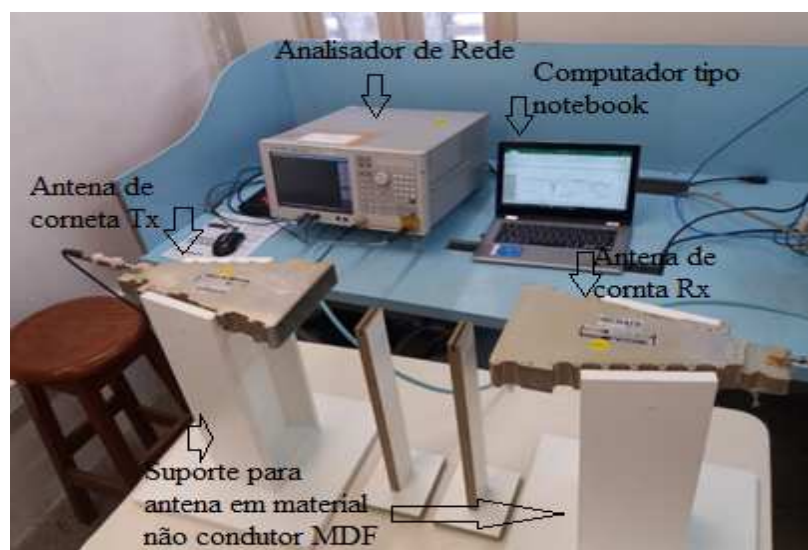
Figura. 5.12: Setup de medição utilizando a técnica do espaço livre
