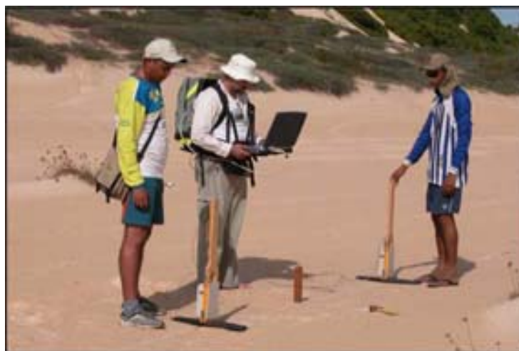
Figura 2.3: CMP ( Common Mid Point ) realizada na área, para a determinação da velocidade de propagação das ondas eletromagnéticas no meio.
