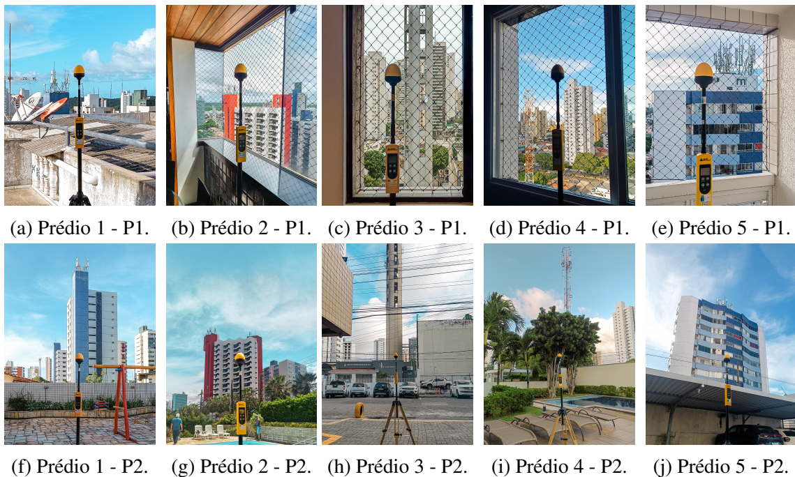
Figura 6.2: Posicionamento do arranjo de medição nos pontos de medição de cada prédio-alvo.
