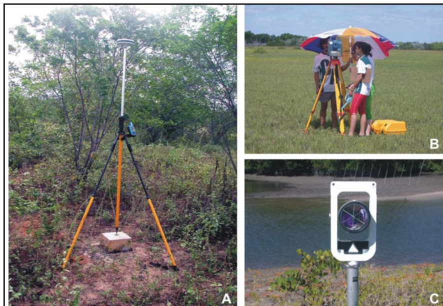
Figura 8.3. Sistema DGPS modelo ProMarck 2/Ashtech (A), estação total modelo Elta 50/Trimble Zeiss (B) e prisma (C).
