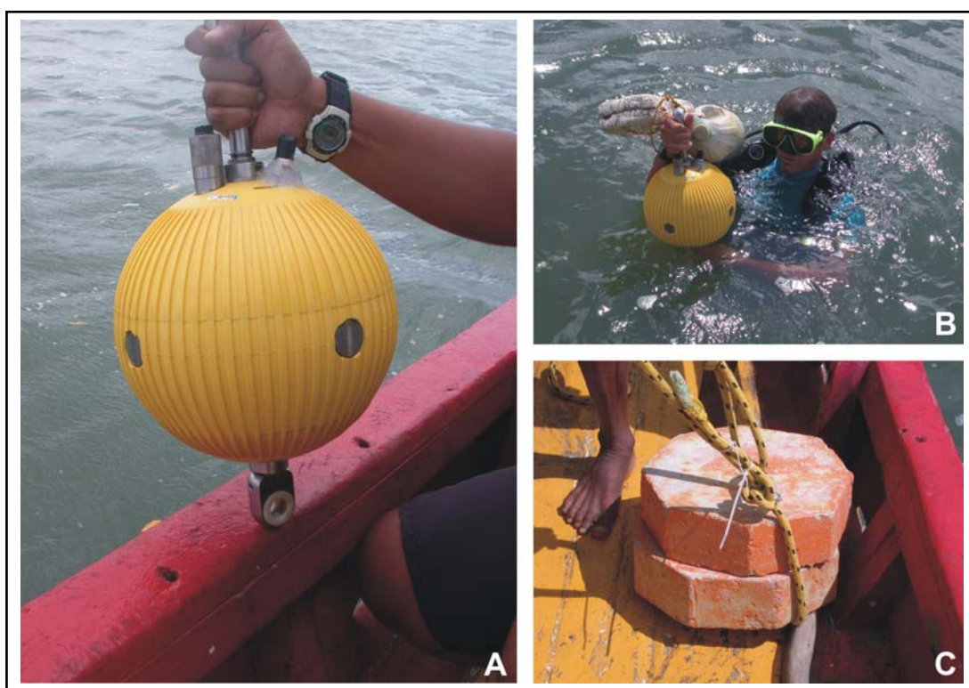
Figura 7.4. Bóia S4 mostrando os sensores para determinação dos parâmetros da corrente (círculos cinza) (A), bóias (branca) para estabilização e verticalização da S4 (B) e peso para fixação da bóia no fundo do canal (C).
