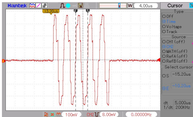
Figura 3.14: Observação via osciloscópio do sinal emitido pelo DAC para uma frequência de 200 kHz e 5 pulsos
