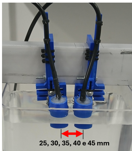
Figura 4.2: Variação da distância entre os transdutores: 25 mm até 45 mm
