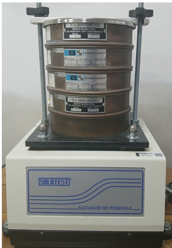
Figura 3.10: Classificação granulométrica das microesferas de vidro (600 \mu\text{m} , 425 \mu\text{m} , 250 \mu\text{m} e 150 \mu\text{m} )
