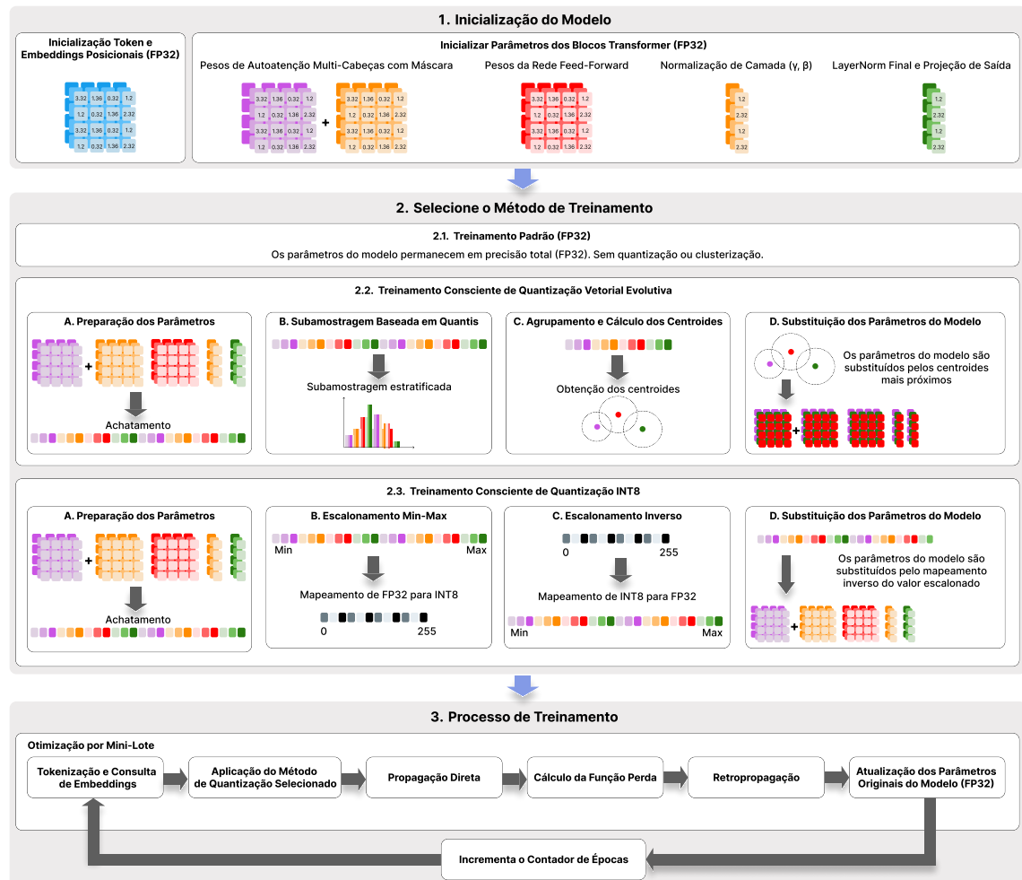
Figura 4.4: Fluxograma do processo de treinamento da metodologia proposta, detalhando as etapas de inicialização, os três modos de quantização (Padrão, Vetorial Evolutiva e INT8) e o ciclo de otimização com atualização dos parâmetros mestres.
