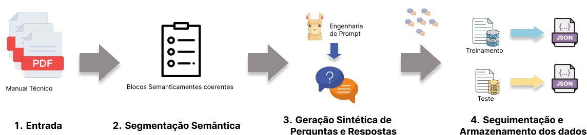
Figura 4.2: Fluxo da ingestão do manual técnico (PDF), segmentação semântica controlada, geração de pares instrução–resposta via LLaMA 3.2 e estruturação final em JSON para treinamento do modelo.
