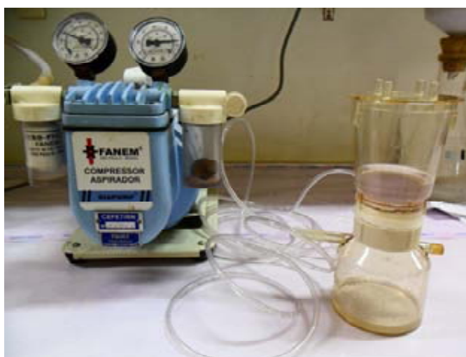
Figura 29 - Porta filtro Millipore Sistema Asséptico Sterifil e bomba de vácuo Tecnal TE-058.
