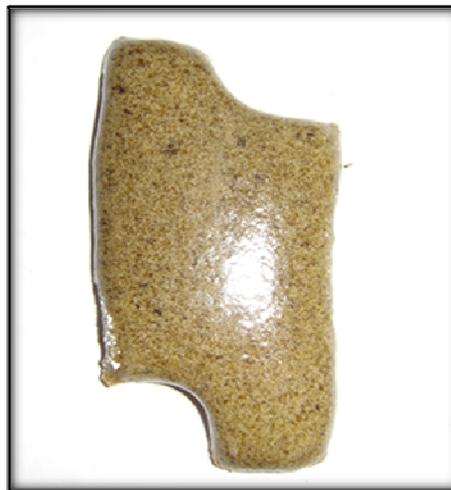
Figura 42: Foto de Corpo de prova da Série Bf fundido, sinterizado a 1150°C.
