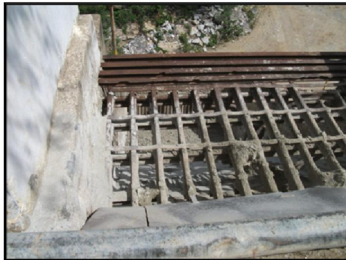
Figura 15: Grelha onde é lançado o minério ao ser retirado da mina.
