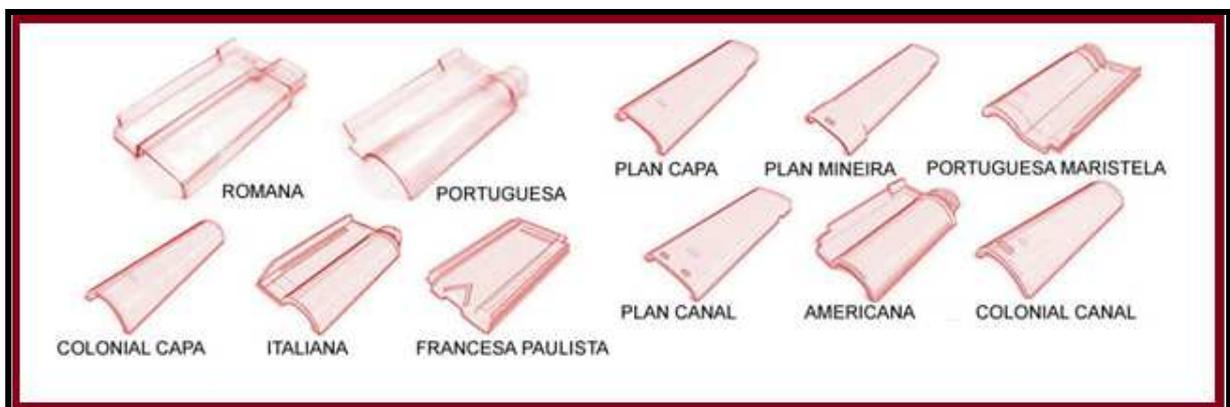
Figura 3: Tipos de telhas cerâmicas.
