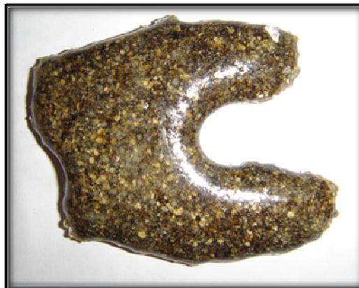
Figura 43: Foto do corpo de prova da Série Bg fundido, sinterizado a 1200°C.
