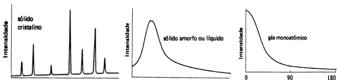
Figura 18 – Exemplos de difratogramas para material cristalino, material amorfo ou líquido e para material monoatômico.
