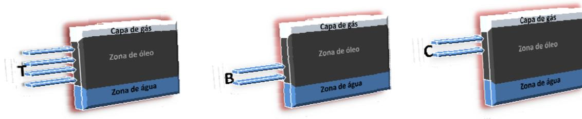
Figura 4. 8. Esquemas de injeção de vapor
