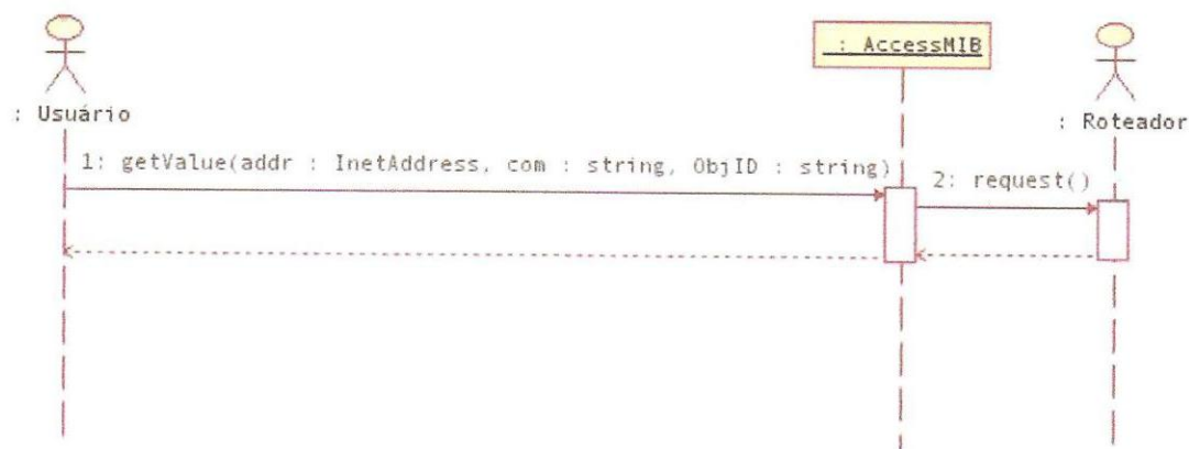
Figura 5.9: Acesso à MIB PIM de roteadores Cisco
