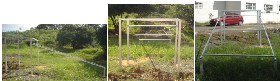
Figura 3.6. Detalhes da montagem do suporte em alumínio.
