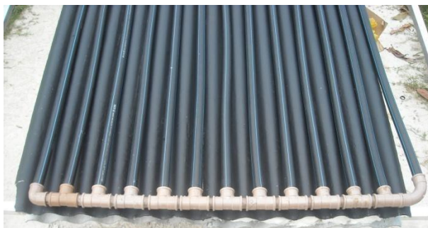
Figura 3.8. Detalhe das conexões na parte inferior do coletor.
