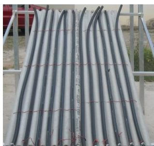
Figura 3.7. Detalhe dos 12 tubos de PEAD da grade absorvedora.
