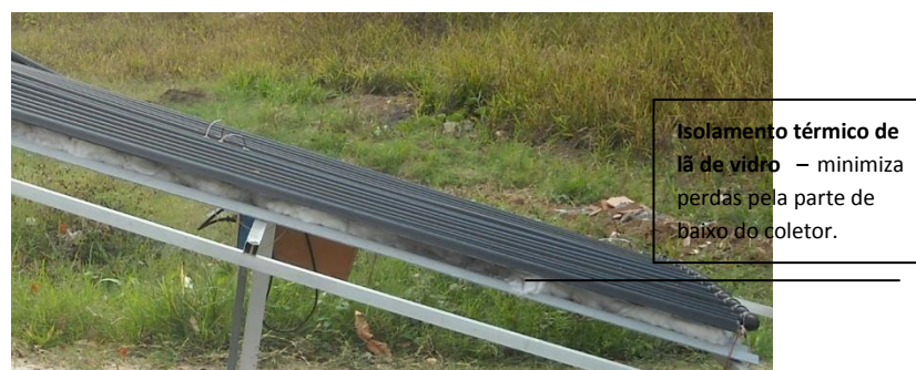
Fig. 3.5. Detalhes do isolamento térmico do coletor.
