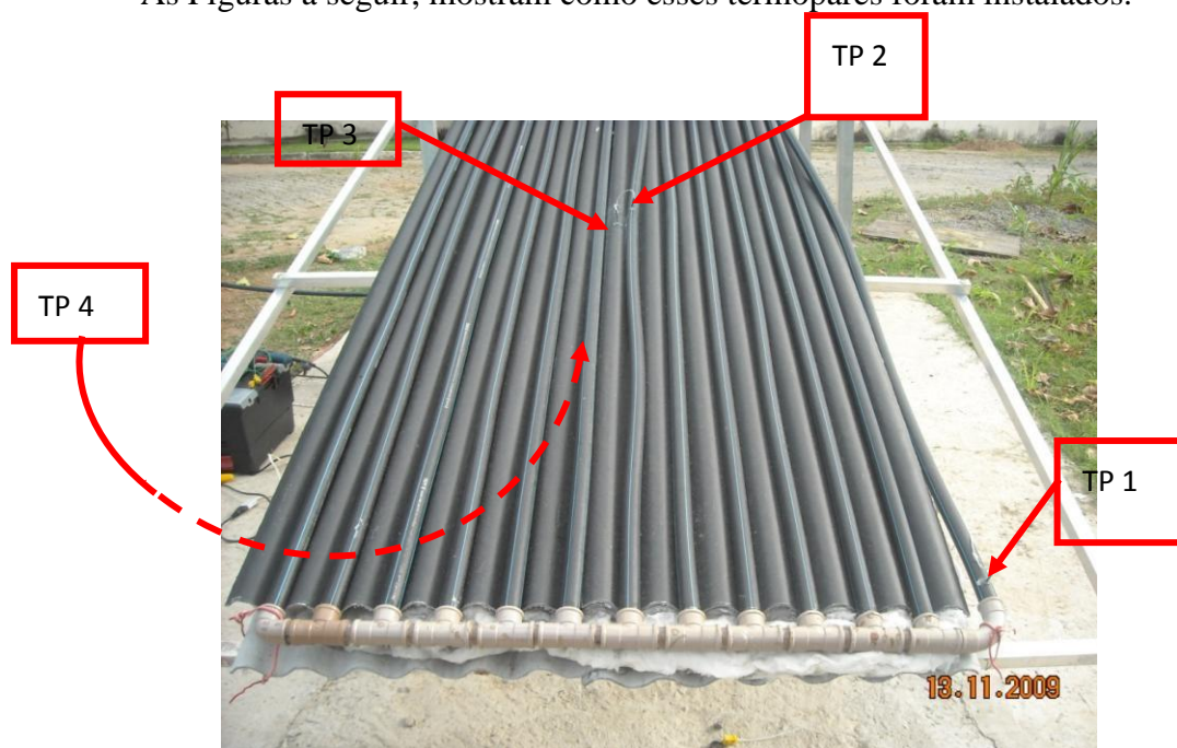
Figura 3.16. Detalhes da instalação dos termopares
