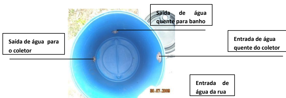
Figura 3.12. Detalhe dos furos vistos internamente.
