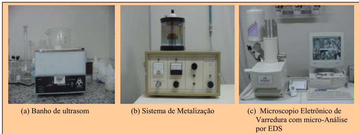
Figura 16 – Equipamentos utilizados nas análises das peças (pino, pistão e cabeçote).
