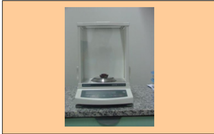
Figura 14 - Registro da medição da massa dos componentes do motor em balança analítica.
