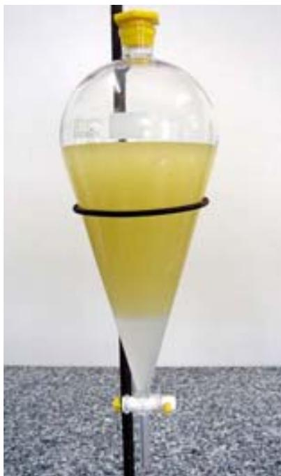
**Figura 3.9** Processo de lavagem do biodiesel metílico.
