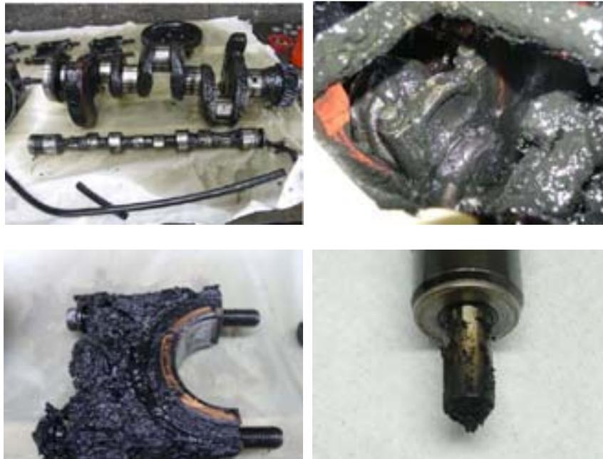
**Figura 2.5** Acúmulo de borras no interior do motor e depósito de carvão no bico injetor, observadas com o uso de óleo bruto de girassol.
