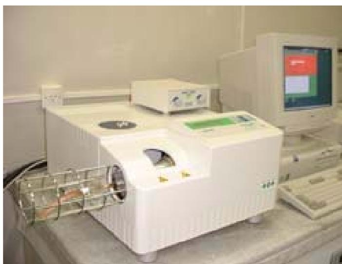
**Figura 3.15** Termobalança utilizada nas análises termogravimétricas do óleo de mamona e do seu biodiesel correspondente.
