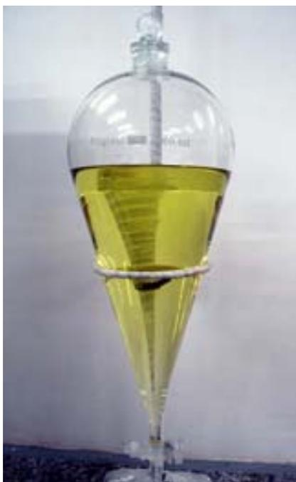
**Figura 3.8** Biodiesel metílico após de retirar a glicerina.
