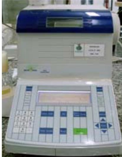
**Figura 3.14** Densímetro digital para determinar a densidade do biodiesel.
