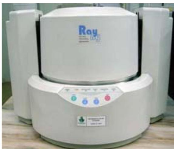
**Figura 2.11** Analisador utilizado para verificar a presença de enxofre por fluorescência por raios-X.
