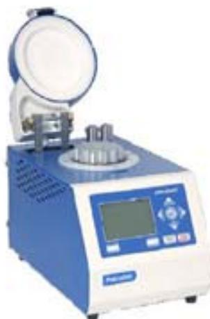
**Figura 3.16** PetroOXY utilizado para determinação do período de indução das amostras de biodiesel de mamona.
