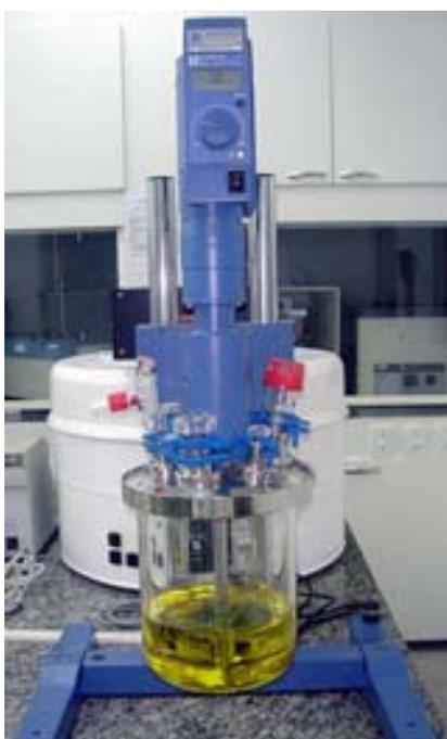
**Figura 3.6** Reator utilizado no processo da reação de transesterificação.
