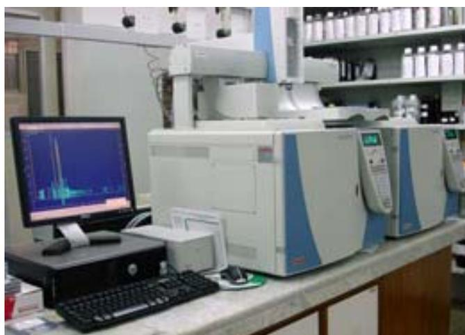
**Figura 3.17** Cromatografo a gás (CG-FID).
