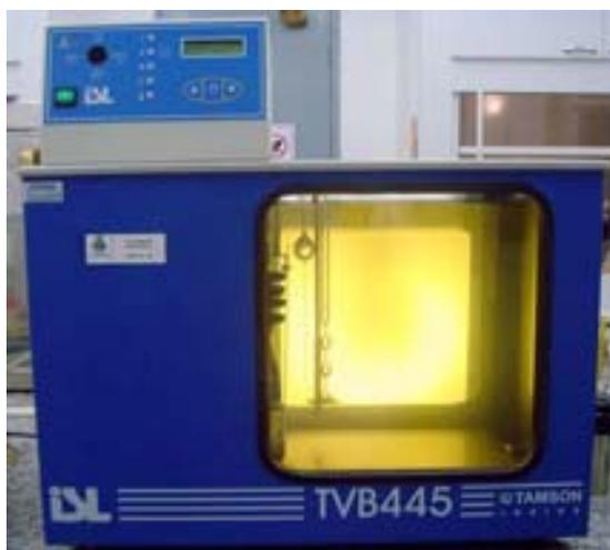
**Figura 3.13** Viscosímetro utilizado de acordo com a norma ASTM 445.
