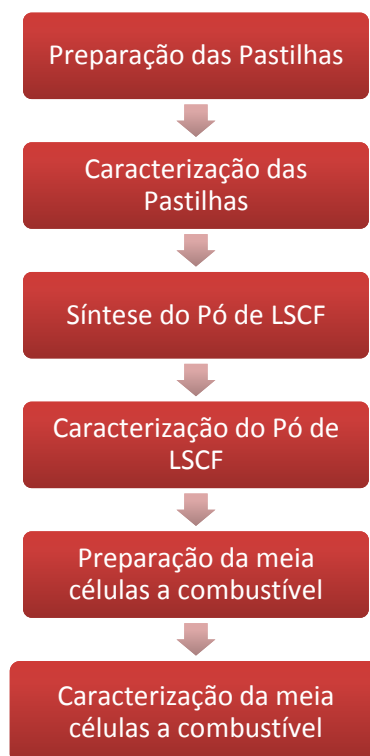
Figura 10 - Etapas de produção de uma meia célula a combustível de óxido sólido.
