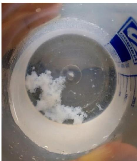
Figura 3.1 - Flocos formados após a agitação.
