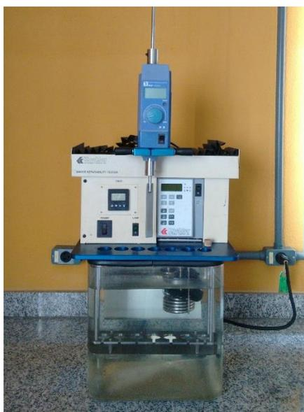
Figura 3.2 - Banho termostático utilizado para análise da variação de temperatura.
