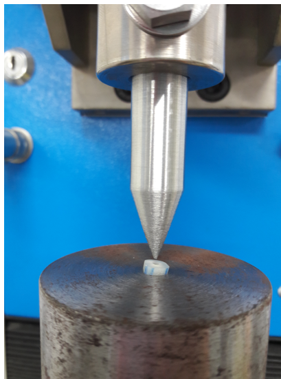
Figura 5. Espécime posicionado em suporte metálico de aço inoxidável e ponta acoplada em máquina de ensaio universal.
